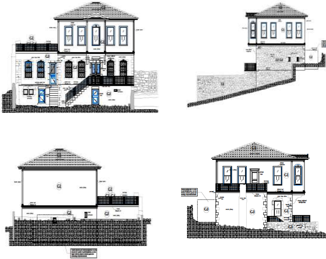
Çizim 7: Kâmil Furtun Konağı Cephe Restitüsyon Çizimleri (Ölçek 1/50 – G1 Eski Fotoğraf, G2 Benzer Örnek, G3 Yapıdaki İzler, G4 Sözlü Veriler)
